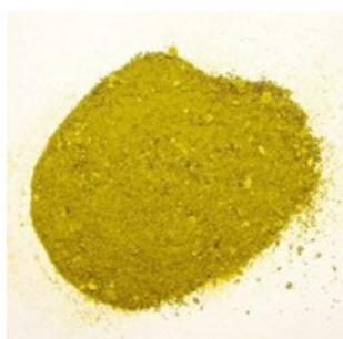
Рис. 3. Гидроксид железа, полученный после кислотно-щелочной обработки гальванического шлама
