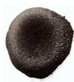
Рис. 4. Железная окалина (маггемит) \text{Fe}_3\text{O}_4 , обладающая магнитными свойствами
