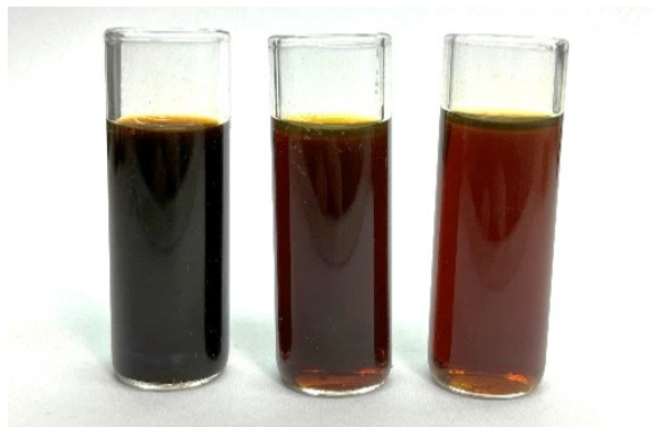
Рис. 1. Внешний вид продуктов пиролиза (слева направо) полиэтилена, смеси полиэтилена/полипропилена 50/50, полипропилена
