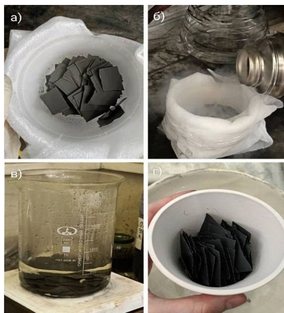
Рис. 1. Сепарация катодных материалов: а) фрагментация; б) низкотемпературная обработка жидким азотом; в) кипячение; г) сушка
