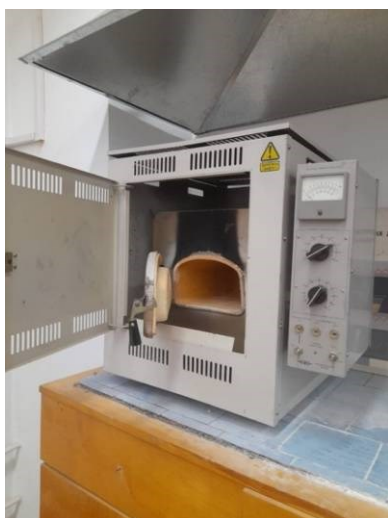
Рис. 1. Лабораторная установка для определения летучих горючих веществ и зольности топлива
