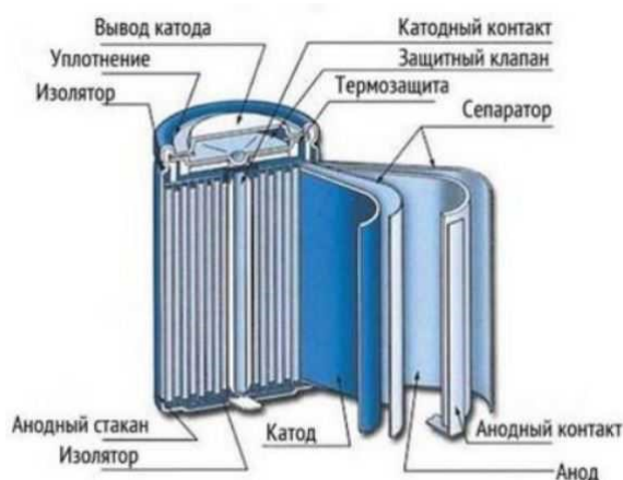
Рис. 1. Схема устройства литий-ионного аккумулятора
