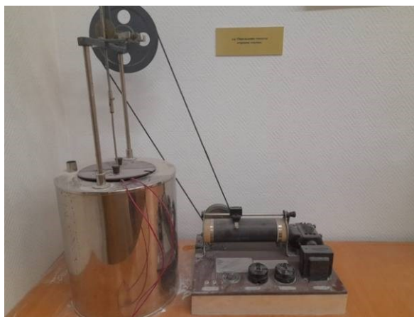
Рис. 2. Калориметрическая установка для определения теплоты сгорания твердого топлива
