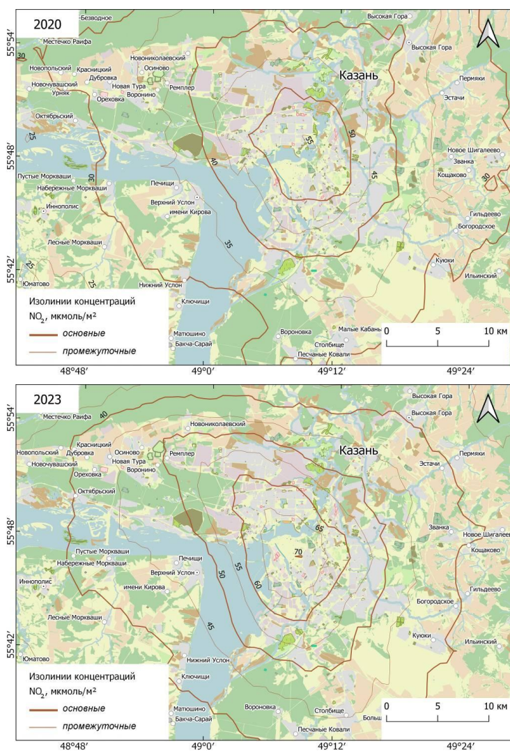
Рис. 2. Изолинии усредненных концентраций диоксида азота в тропосфере на карте-схеме территории г. Казани в 2020 и 2023 гг. по данным спутникового мониторинга
