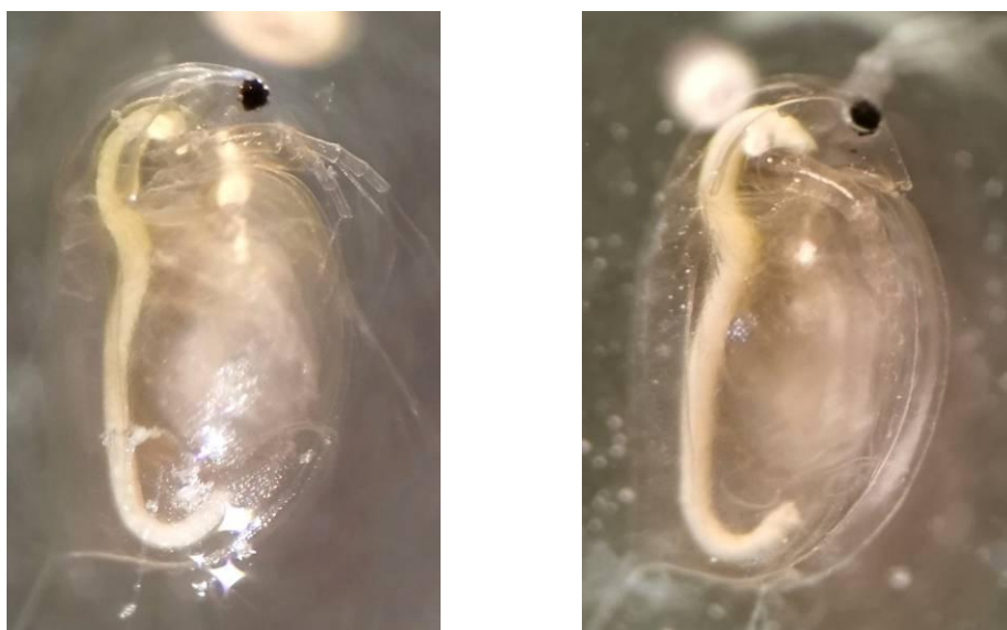
Рис. Внешний вид и содержание пищевого тракта дафний после 48 ч экспозиции с применением микрочастиц полистирола с концентрацией 50 мкг/л (слева) и нано- и микрочастиц диоксида титана с концентрацией 50 мкг/л (справа)
