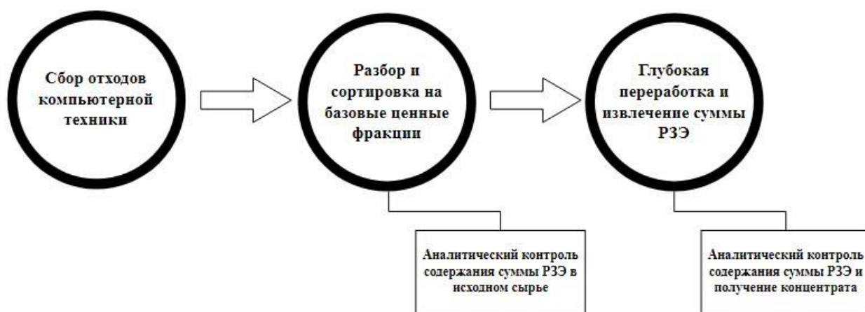
Рис. Схема переработки отходов компьютерной техники
