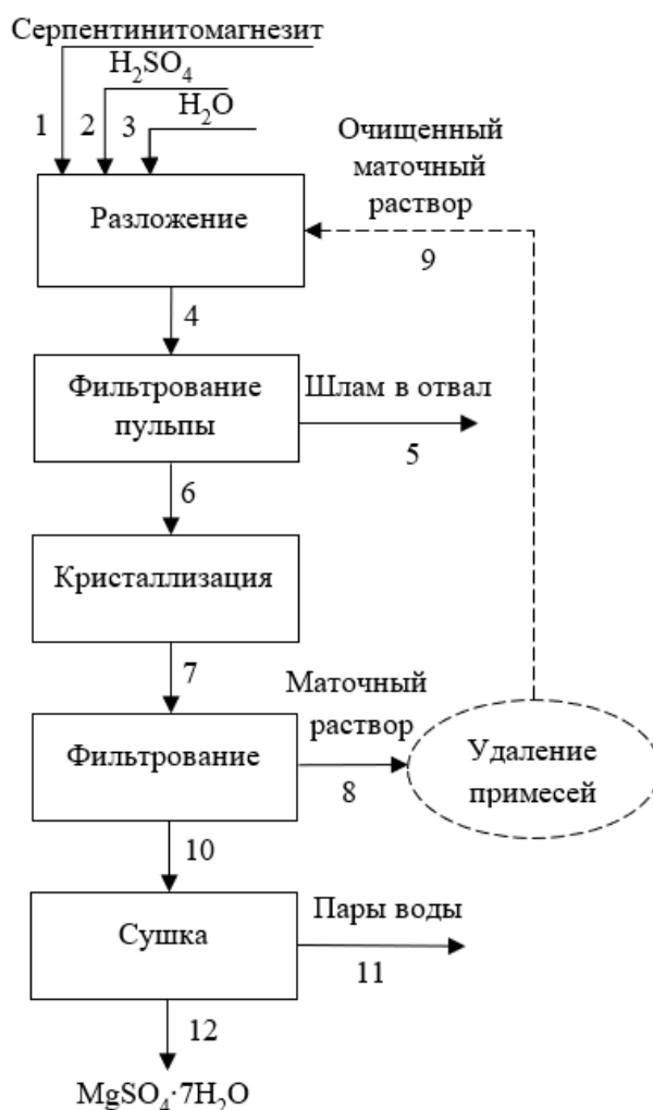
Рис. 1. Блок-схема сернокислотного разложения серпентинитомагнезита на сульфат магния
