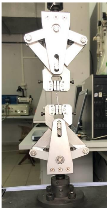
Рис. 2. Испытание на разрывной машине
