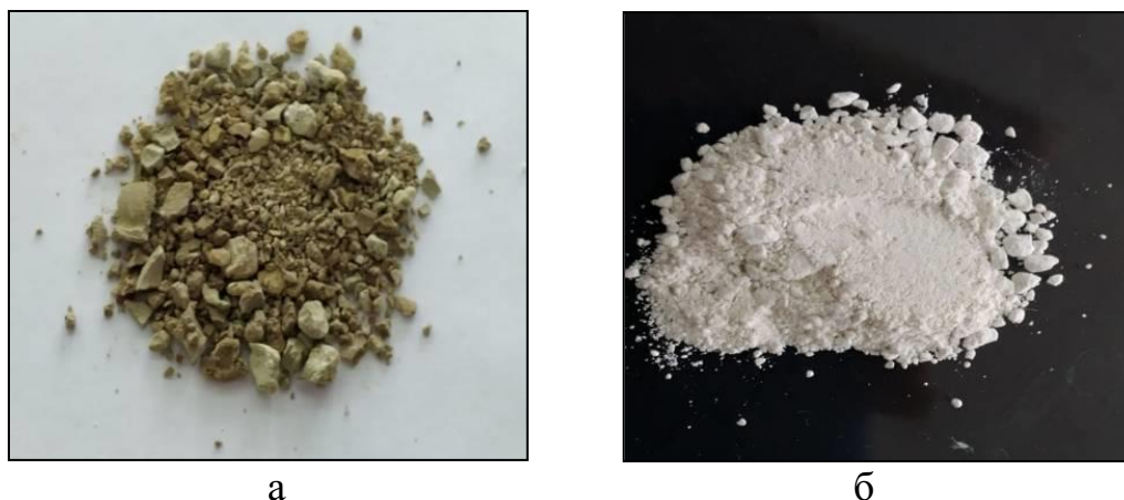
Рис. 2. Вещества, полученные при утилизации отхода гальванического производства: а – оксид хрома(III), б – оксид цинка
