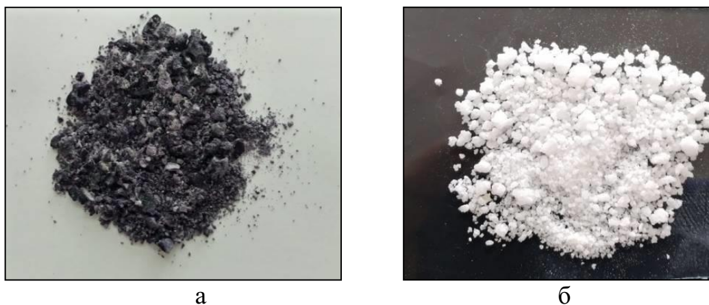
Рис. 1. Вещества, полученные при разделении модельной смеси: а – оксид хрома(III), б – оксид цинка
