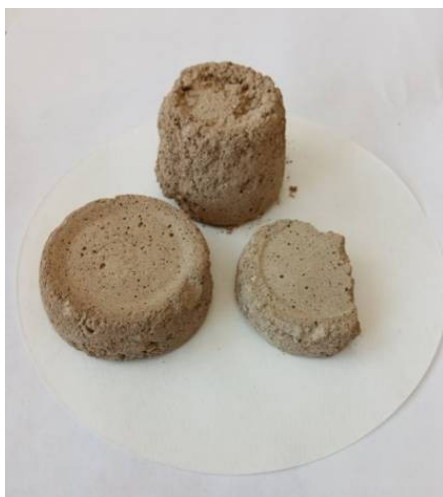
Рис. Вид материалов на основе гипсового связующего, полученного при утилизации отходов нанесения цинковых покрытий
