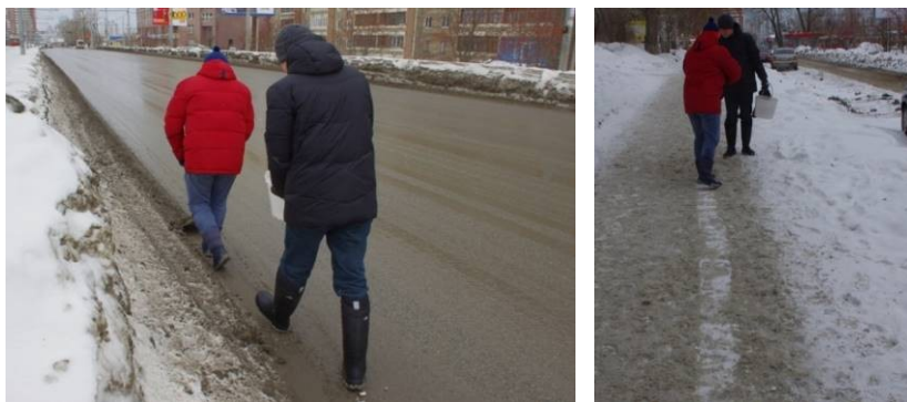
Рис. 2. Отбор проб снежногрязевой пульпы на дороге и на тротуаре с наружной стороны жилого квартала (г. Екатеринбург)
