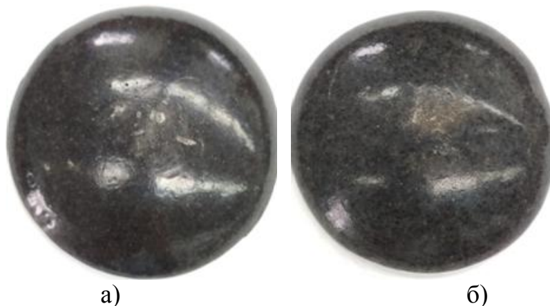
Рис. 4. Внешний вид композитов с содержанием золы 7,5 г после механического испытания с применением: а) магнитной фракции, б) немагнитной фракции
