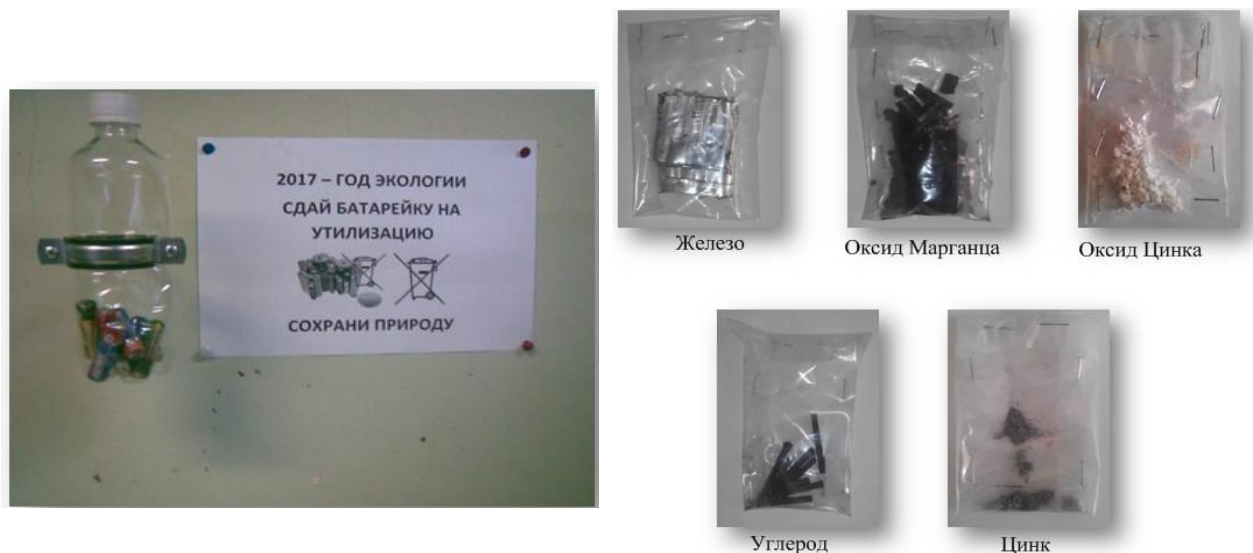
Рис. 1. Организация мест сбора использованных ХИТ и материалы, полученные при утилизации щелочных и солевых ХИТ
