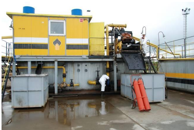
Рис 2. Работа установки по переработке жидких нефтяных отходов
