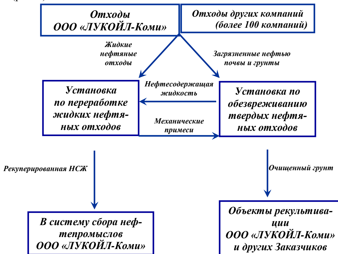
Рис. 1. Схема системы сбора и обезвреживания нефтяных отходов
