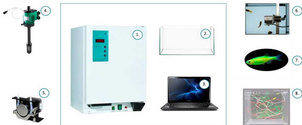
Рис. 1. Составные компоненты системы биоэлектронной регистрации качества воды «TrackTox-Fish»
