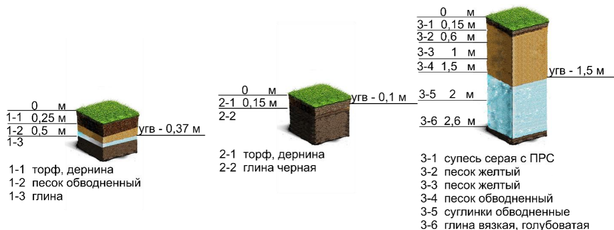
Рис. 2. Литологические колонки, отображающие схему отбора проб по глубинам (1-1 0,25 м – № пробы и глубина отбора)
