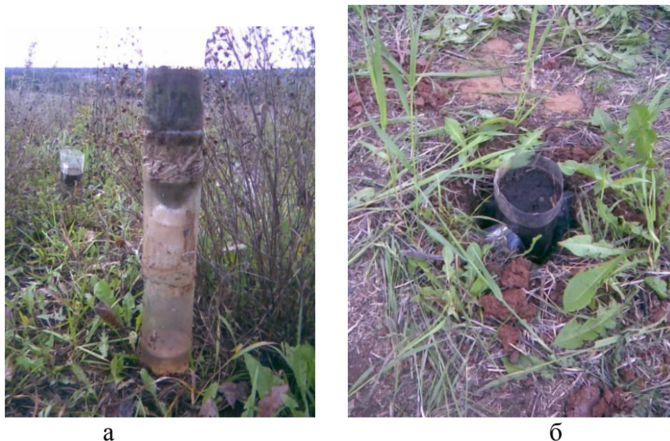
Рис. 2. а – вид устройства для полевых испытаний с загрязненной почвой; б – установка устройства в углубление в грунте
