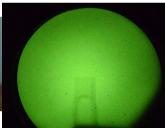
Рис. 3. Визуализация кюветы до проведения реакции Фентона
