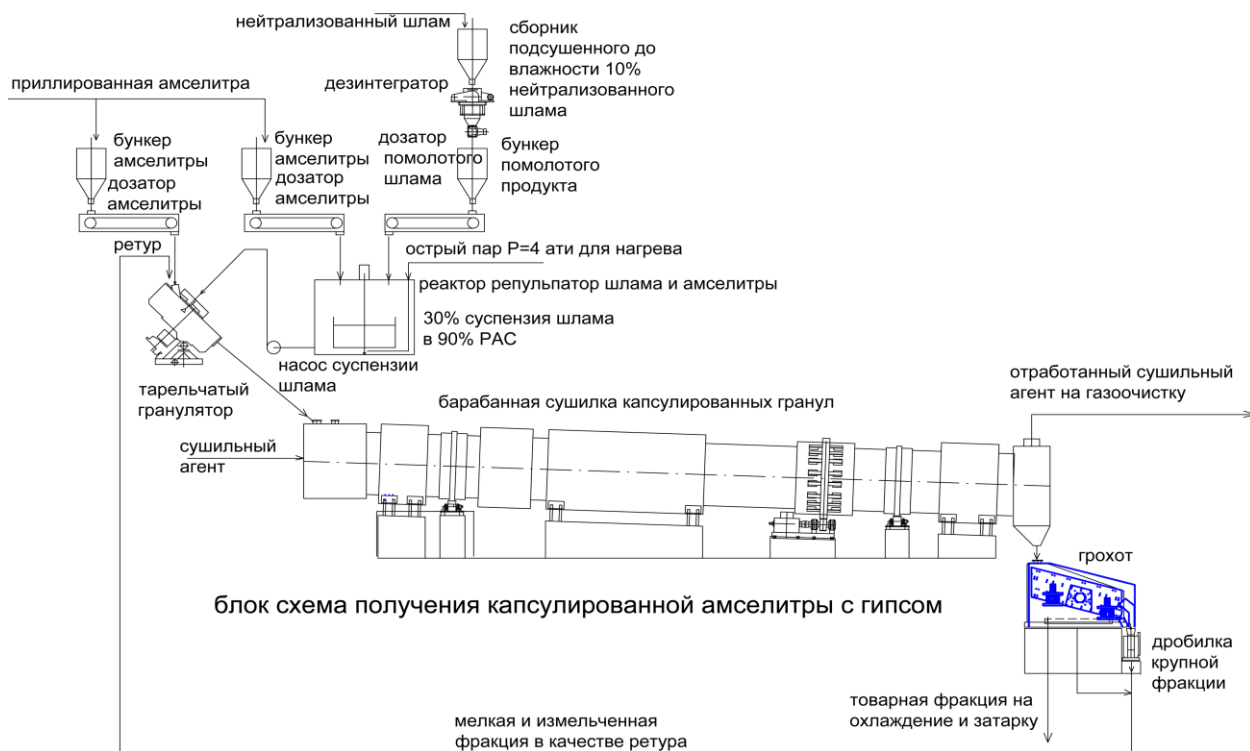
Рис. Промышленная схема гранулирования композиции аммиачной селитры и нейтрализованных шахтных шламов
