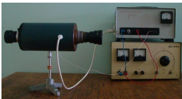
Рис. 2. Электронно-оптический преобразователь типа У-51
