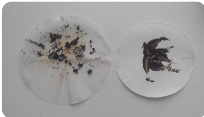
Рис. Общий вид сорбента с сорбированным нефтешламом (левая часть рисунка). Бумажный фильтр с нанесенным на него нефтешламом (правая часть рисунка)
