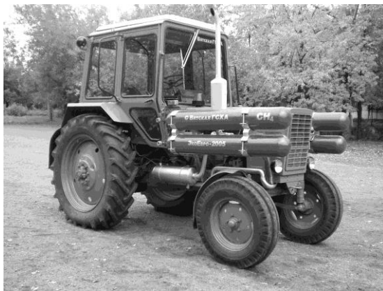
Рис. 2. Общий вид трактора МТЗ-80 с системой питания, модернизированной для работы на природном газе с системой РОГ
