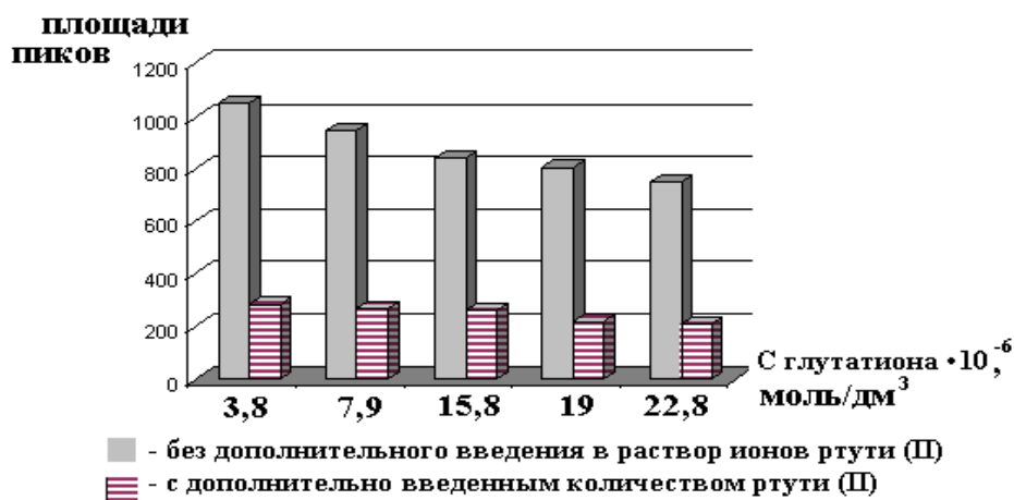
Рис. 3. Влияние ионов ртути (II) на площадь пика: а – величина площади пиков вольтамперограмм, снятых из растворов глутатиона без добавления нитрата ртути (II); б – с добавлением нитрата ртути (II)
