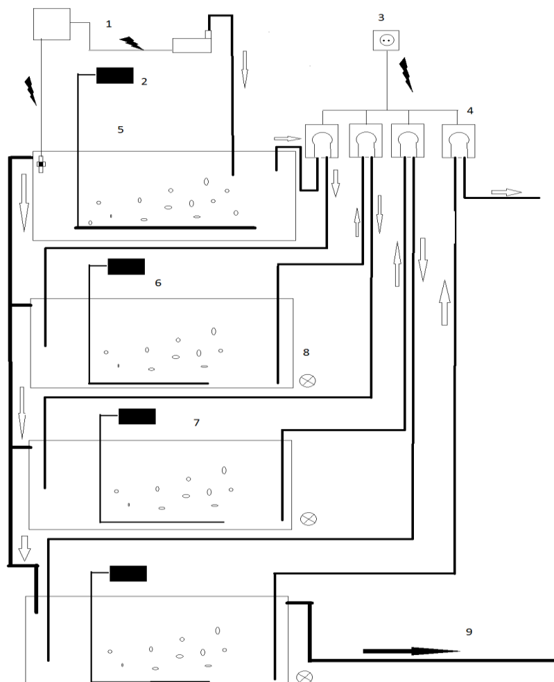
Рис. 2. Аквариумный комплекс для содержания и разведения маточных культур гидробионтов: 1 – автодолив с насосом; 2 – компрессор; 3 – система таймеров; 4 – система дозирующих перистальтических насосов; 5 – аквариум для выращивания водорослей; 6, 7, 10 – аквариумы для выращивания различных беспозвоночных или молоди рыб; 8 – лампы; 9 – слив. Стрелками показано направление движения воды: темные стрелки – слив из аквариумов, светлые – залив в аквариумы. Молниями обозначены провода
