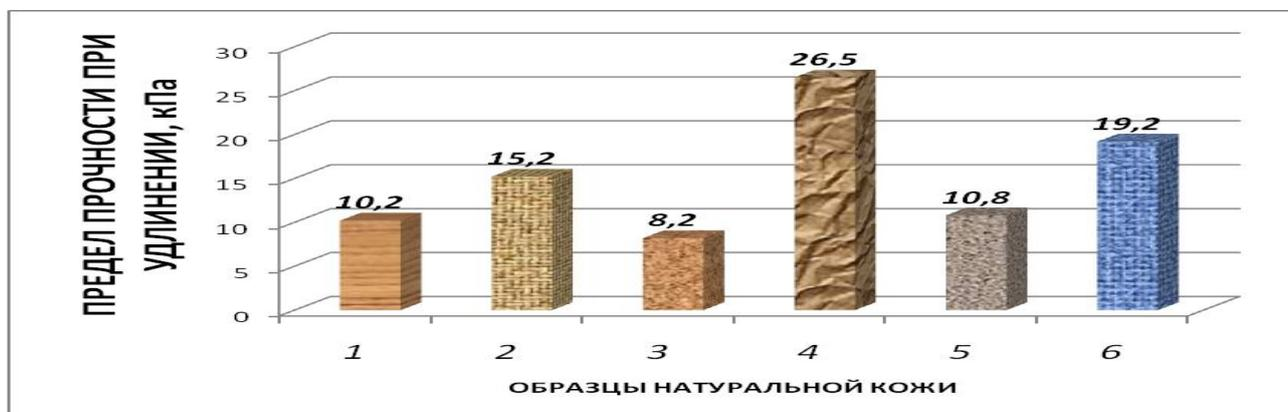
Рис. 3. Предел прочности при удлинении натуральных кож, кПа\*
