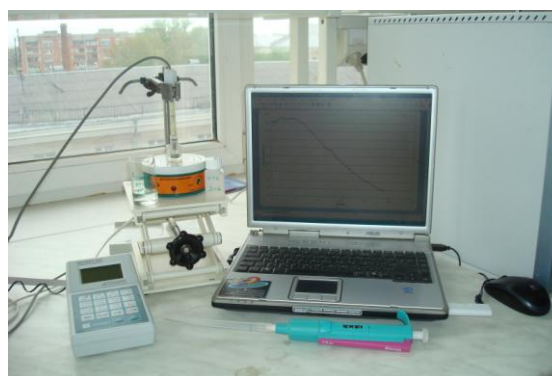
Рис. 1. а) Схема работы биосенсора кюветного типа; б) Внешний вид лабораторной модели БПК-биосенсора кюветного типа
