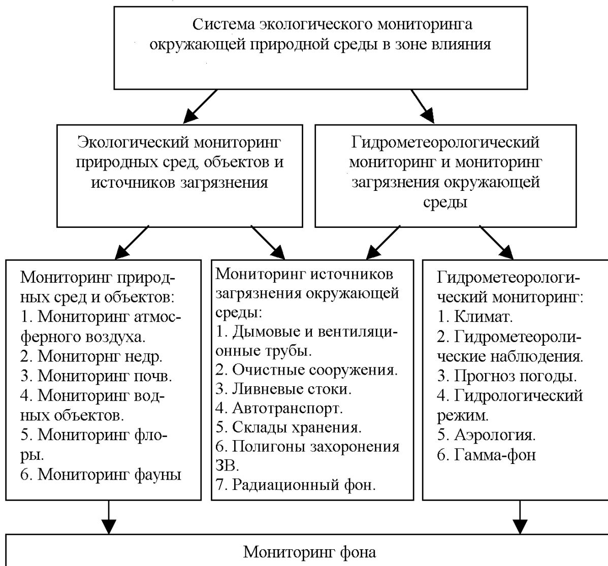
Рис. 3. Структура комплексного экологического мониторинга окружающей природной среды в зоне техногенного воздействия и на территории фона
