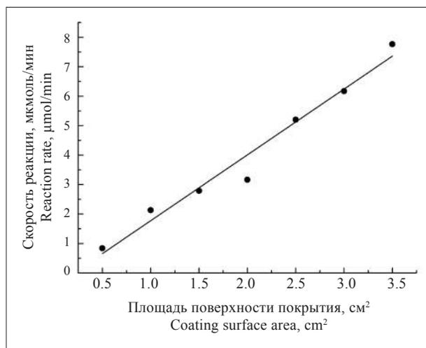
**Рис. 5.** Зависимость скорости реакции фотокаталитической деструкции азорубина от геометрической площади покрытий из НТ TiO<sub>2</sub>
