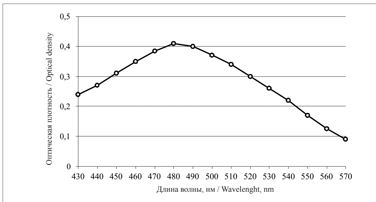
Рис. Спектрограмма, снятая с экстракта (смесь ацетона с уксусной кислотой в соотношении 1 : 1) из цианобактерии Nostoc paludosum 18 Fig. Spectrogram of an extract (mixture of acetone and acetic acid in a 1 : 1 ratio) from the cyanobacterium Nostoc paludosum 18
