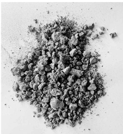
**Рис. 1.** Вид твёрдого отхода гальванического производства по нанесению цинковых покрытий
