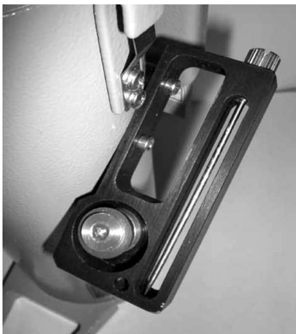
Рис. 4. Доработанное устройство для вскрытия ампул аспиратора АПХ-03.
