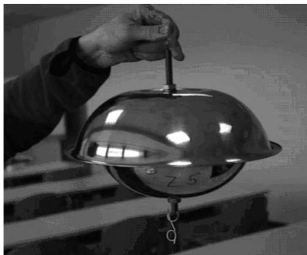
Рисунок. Внешний вид пробоотборника для определения СОЗ [7]
