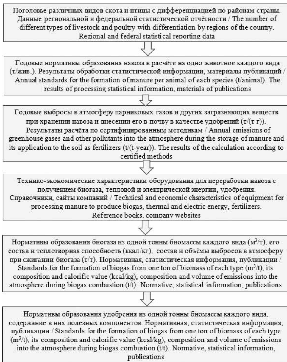
Рис. 1. Исходная информация для проведения оценки потенциалов Fig. 1. Background information for the capacity assessment
