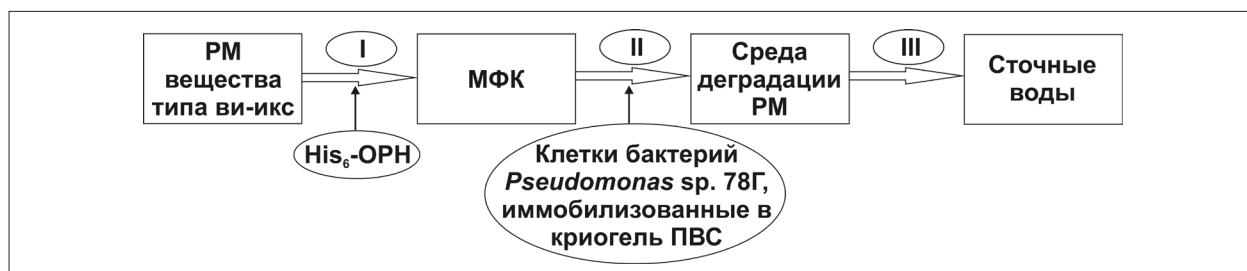
Рис. 1. Принципиальная схема биоразложения фосфорорганических компонентов РМ вещества типа ви-икс, использованная в работе и состоящая из трёх основных стадий: I – разложение в составе РМ остаточных концентраций вещества типа ви-икс и эфиров МФК; II – разложение МФК, III – доочистка сточных вод под действием аэробного активного ила.
