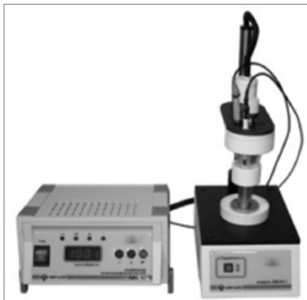
Рис. 1. Электрохимический комплекс для определения гидразина на основе компьютерного вольтамперометрического анализатора и системы сенсоров/электродов, объединённых в единой электрохимической ячейке.
