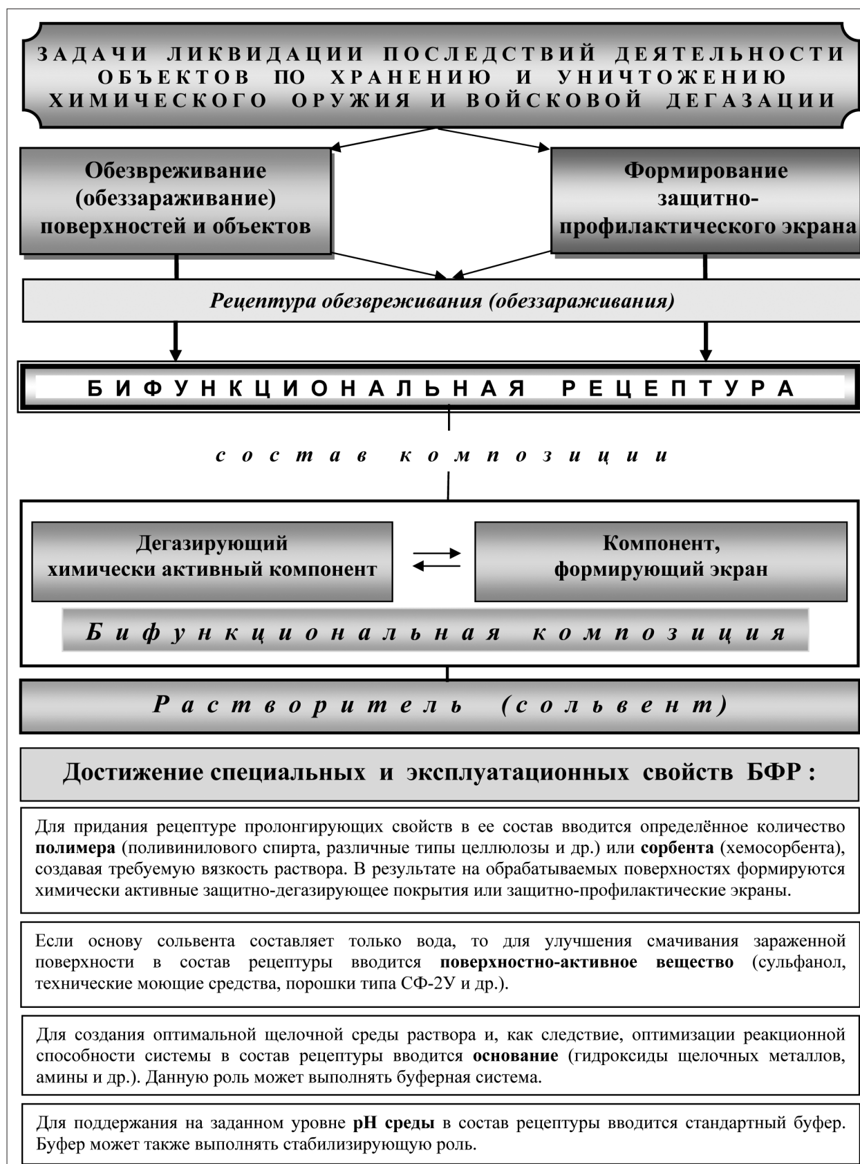
Рис. 3. Алгоритм разработки полидегазирующей (бифункциональной) водной (водно-органической) рецептуры (пролонгирующего действия).
