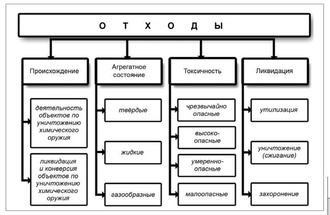
Рис. 1. Характеристика отходов объектов по уничтожению химического оружия
