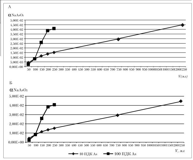
Рис. 1. Зависимость степени выделения α NaAsO<sub>2</sub> (в долях от исходного содержания) от объёма пропущенной воды — V (мл): А) через образец почвы № 4 при скорости фильтрации воды ω ~ 2,8 · 10·² мл/с;
