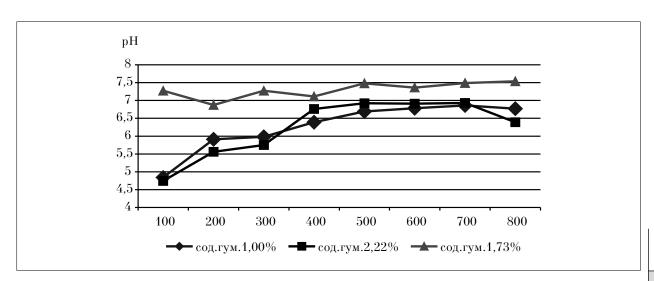
Рис. 2. Значение рН фильтрата после прохождения через загрязнённые почвенные образцы Камбарского района с различным содержанием гумуса, скорость фильтрации воды через загрязнённый образец ~6,94·10<sup>-3</sup> мл/с, загрязнение арсенитом натрия 12,5 ПДК по As
